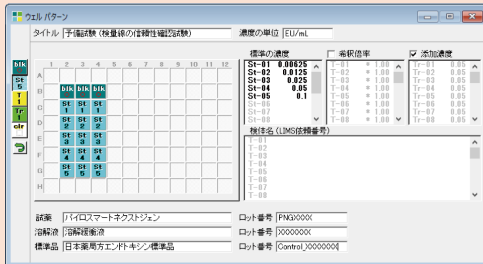
ウェルパターン例：予備試験 (検量線の信頼性確認試験)
